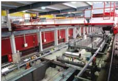
Поточная линия сборки металлоконструкций
